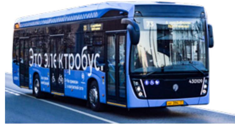
El Kamaz 6282, ofrece hasta 70 km de autonomía en una carga de sus baterías de litio-titanio, las cuales se pueden recargar entre 6 y 12 minutos, si se emplea una estación de carga ultra-rápida, a través de un pantógrafo. También dispone de la opción de carga normal desde una toma trifásica de 380 V, que Kamaz denomina carga nocturna.
