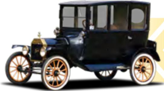
La Compañía Ford lanza el modelo Ford T que presentaba varias innovaciones: volante a la izquierda, motor y transmisión cerrados, cuatro cilindros encajados en un bloque sólido y suspensión mediante dos muelles semielípticos. El automóvil era muy sencillo de conducir, barato y fácil de reparar.
