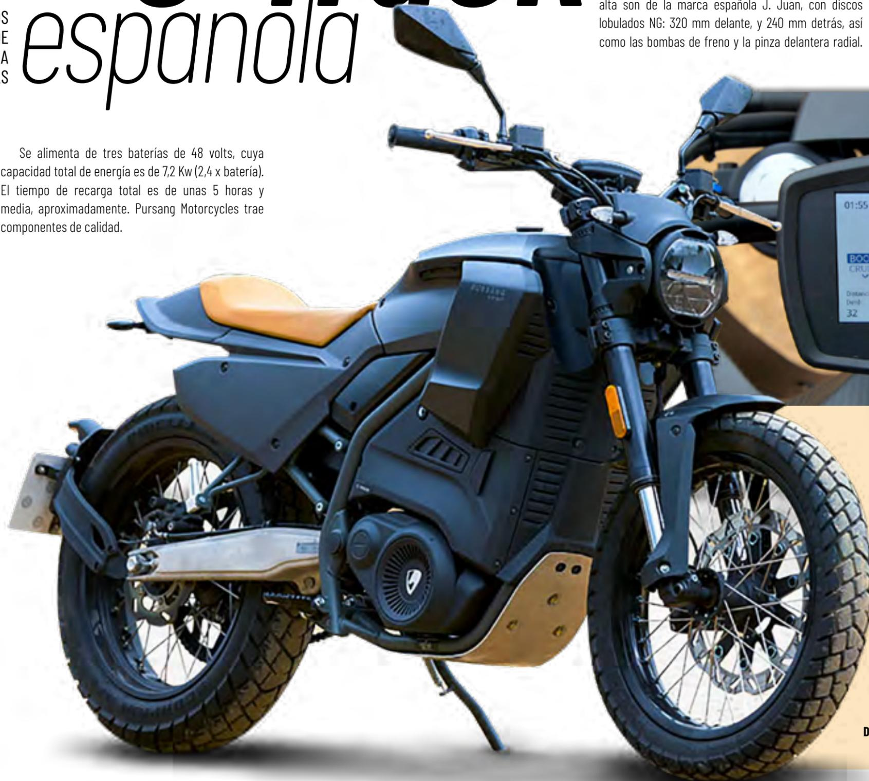
Sumados al motor eléctrico alemán Bosch, cuenta con un chasis de doble cuna, de cromo-molibdeno, basculante de fundición en aluminio cepillado, así como horquilla invertida de 41 mm, delante, y monoamortiguador con bieletas (ambos de la firma Ollé). Los frenos de gama alta son de la marca española J. Juan, con discos lobulados NG: 320 mm delante, y 240 mm detrás, así como las bombas de freno y la pinza delantera radial.
