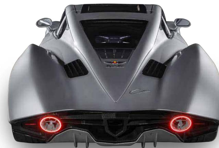
Este híper-deportivo ibérico está equipado con un sistema de propulsión eléctrica compuesto por dos motores, ambos en las ruedas traseras, que generan una potencia de 1 020 CV/750 kW. Cada motor está colocado en su respectiva rueda, de forma transversal, con 510 CV/375 kW y con una tensión nominal de 750 V. Se alimentan de una batería de 80 kWh. Tiene recuperación de energía por frenado. Su autonomía es de 400 km.
