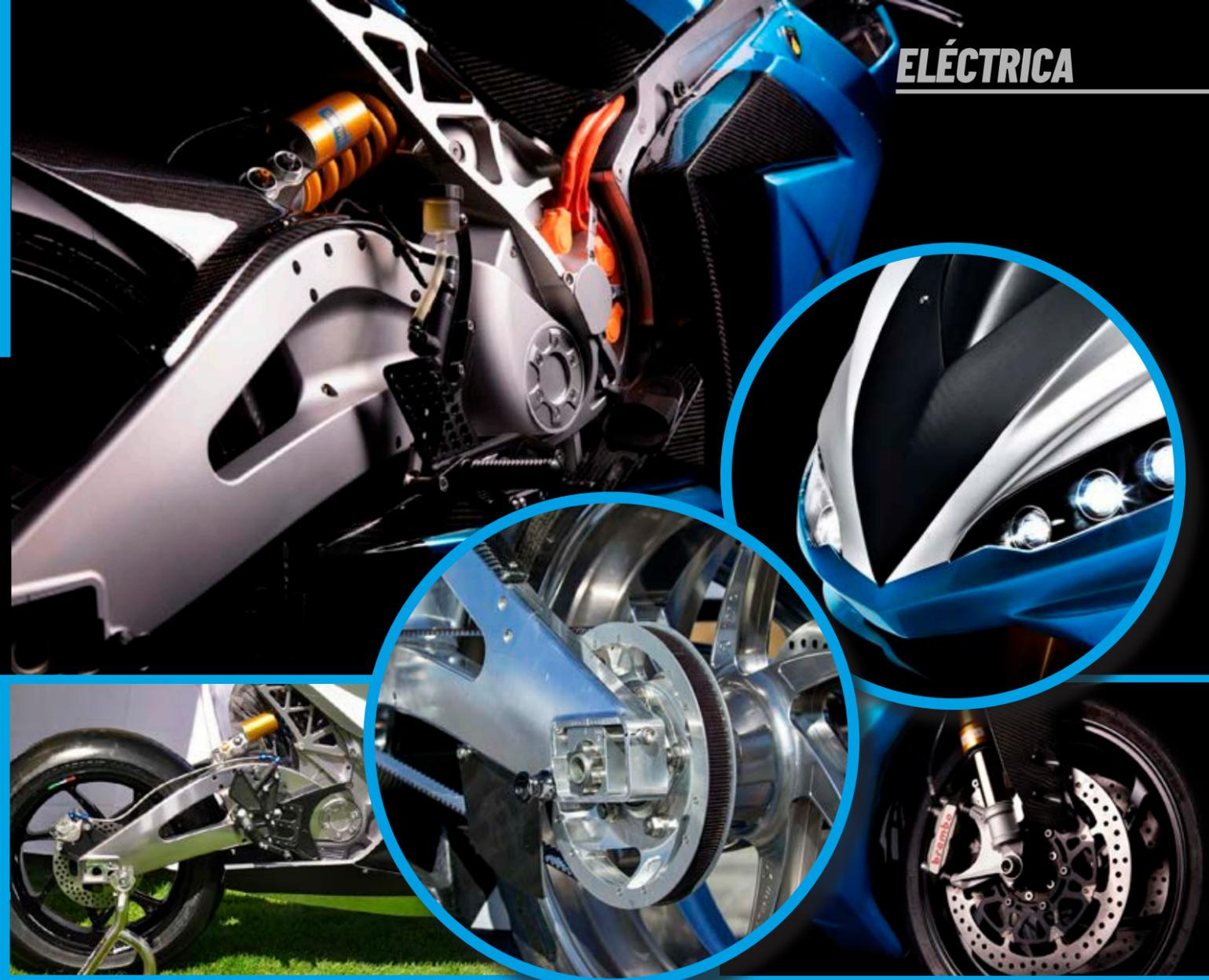
Para conseguir las extraordinarias prestaciones que tiene la Lightning LS-218, se le montó un motor eléctrico síncrono de imanes permanentes, que es refrigerado por líquido, de 200 CV (150 kW) de potencia a 10 500 rpm, lo que la inscribe entre las grandes súper motos del mercado. Y otra de las sorpresas es su par motor, de 228 Nm ¡Prácticamente el doble de la súper Ducati Panigale!
