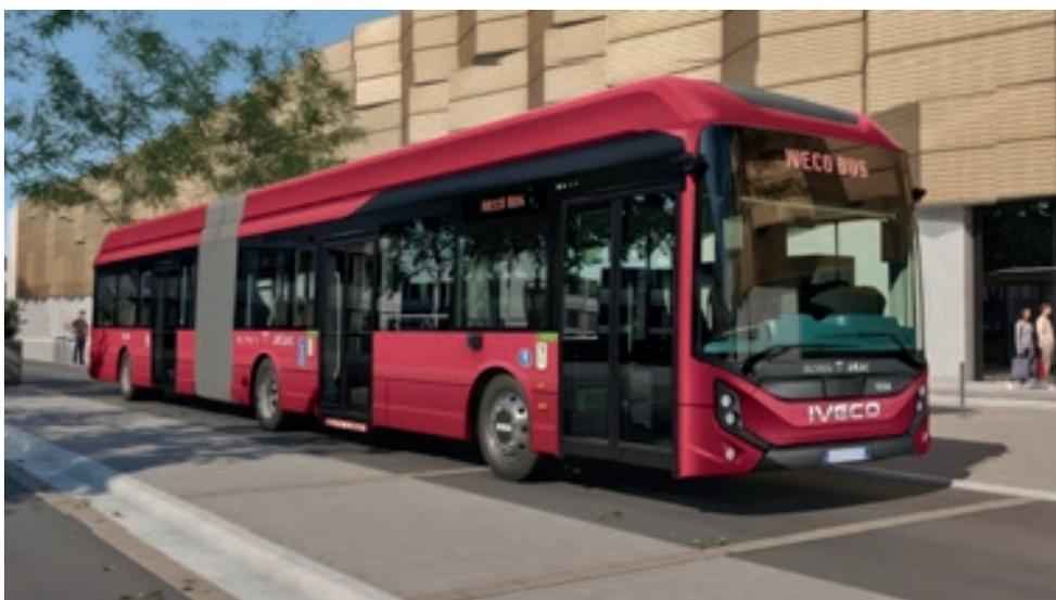
Para los buses eléctricos articulados hay configuraciones de seis a nueve paquetes de baterías, que proporcionan una capacidad de 416, 485, 554 o 624 kW/h, respectivamente. Se estima una autonomía de 500 km.
