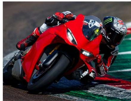
El motor es el Desmosedici Stradale homologado con la norma Euro5+ que entrega 216 CV a 13,500 rpm y un par máximo de 12.3 Nm a 11,250 rpm. El motor comparte soluciones técnicas con la Ducati GP24 de MotoGP: su arquitectura V4 a 90° y distribución desmodrómica con el cigüeñal contra-rotante. Con el sistema de escape de competición: el Ducati Performance Akrapovi, la potencia máxima aumenta a 228 CV.
